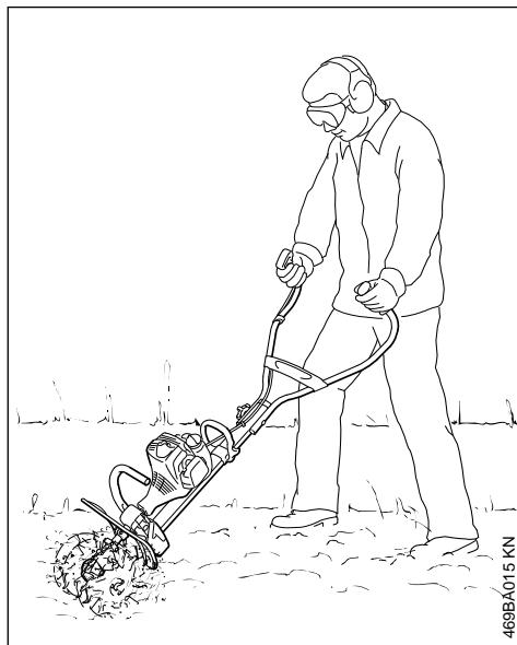
MultiWerkzeuge mit Hackstern zur Bodenbearbeitung gibt es in den Ausführungsarten Bodenfräse BF-MM und Bodenkrümmer BK-MM.
